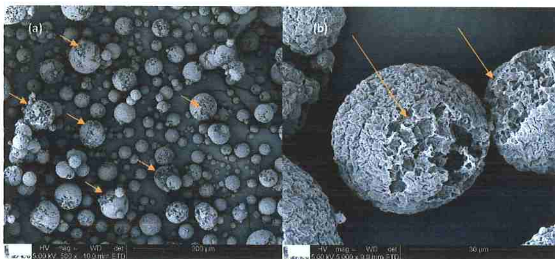
Figura 11. MEV de microcápsulas de PHB com óleo de Copaíba encapsulado (a) 500 x e (b) 5.000 x de aumento.
